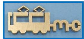
図4 NCワイヤ放電加工作業とその作成例
