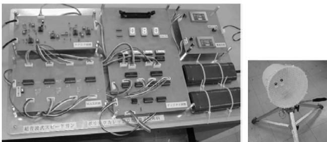
図 20 「スピードガン」の基板と送受センサ
