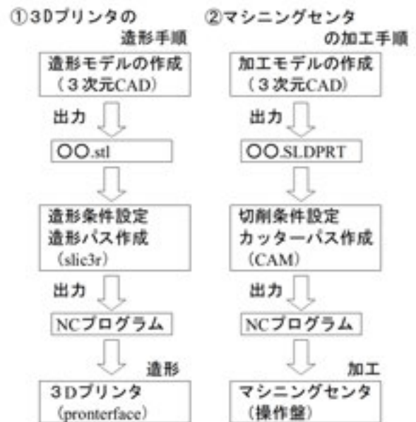
図4 3Dプリンタとマシニングセンタの作業手順
