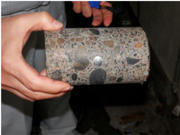
図 25 コンクリートコア(コア No.2) 3)
