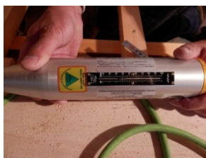
図 17 テストハンマー 3) 図 18 テストハンマー調査
