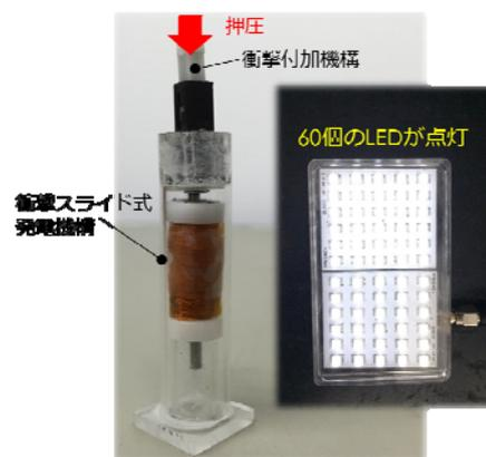
図 6 1 回の衝撃付加による LED パネルの点灯
