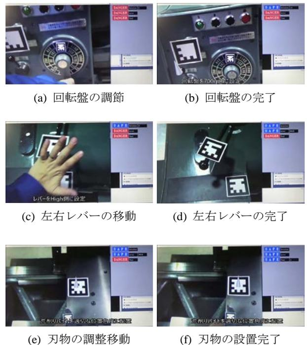
図9 旋盤準備視認作業の様子
