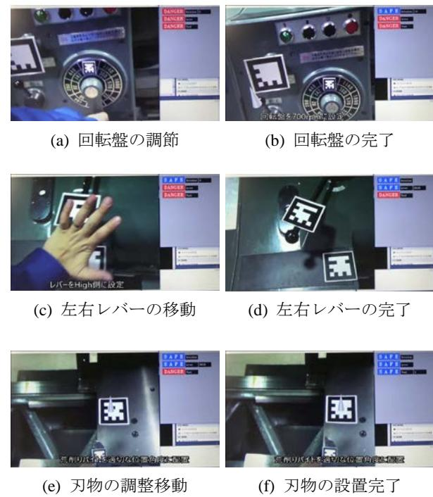
図 9 旋盤準備視認作業の様子
