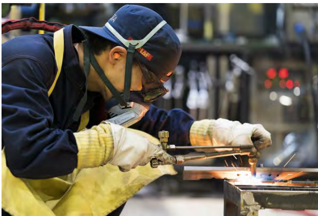
(a) 選手の作業風景 (ガス切断)
