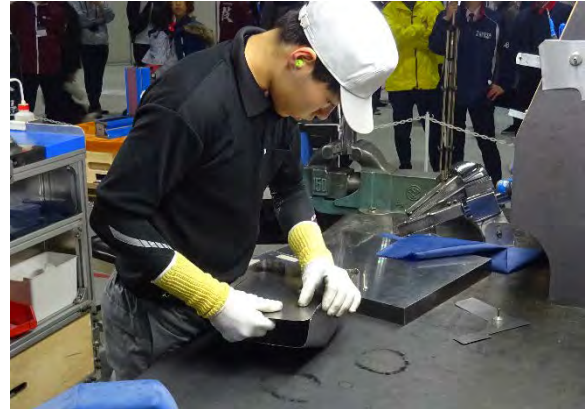
写真4 接合部の隙間や段差の調整
