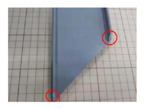
・ダクト同士を写真のように突き合わせる場合には、写真に示すような隙間が空かないよう にすることが望ましい。
