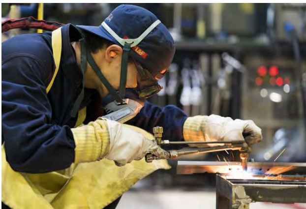
(a) 選手の作業風景 (ガス切断)
