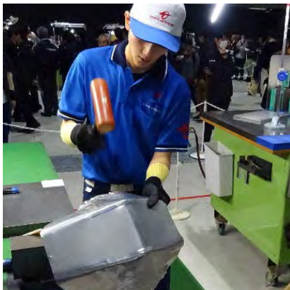
写真3 力強い打ち出し作業
