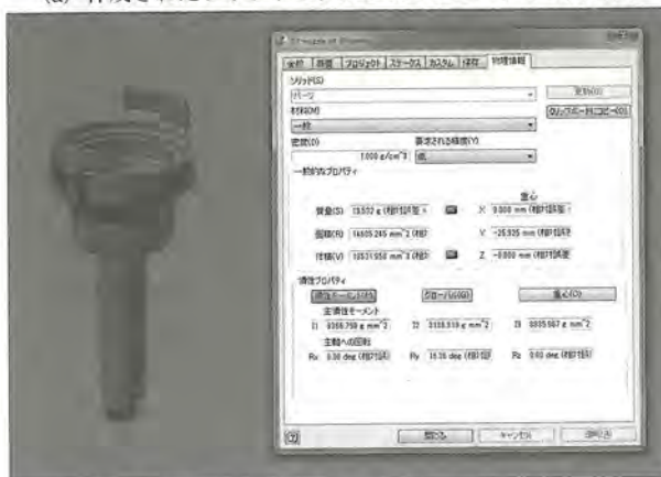
(b) 作成されたソリッドモデルとマスプロパティの解答図
