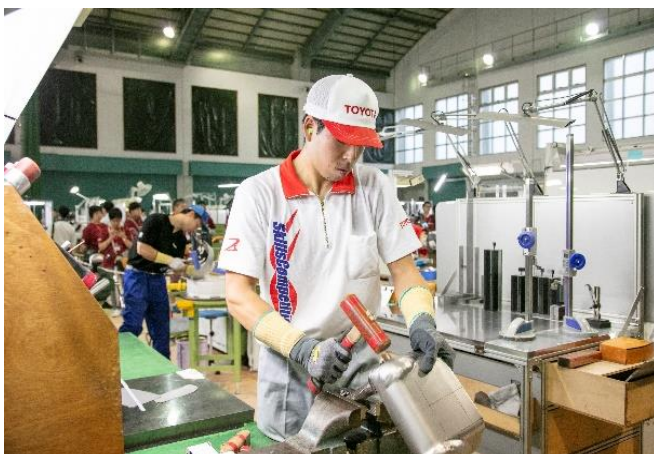
図3 力強い打ち出し作業
