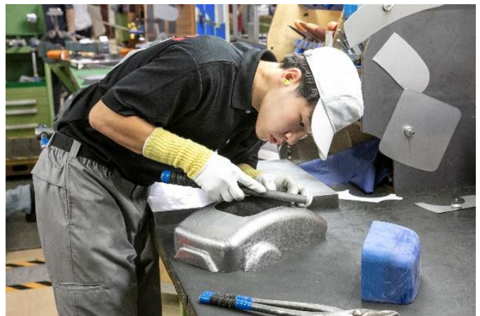
図4 接合部の隙間や段差の調整
