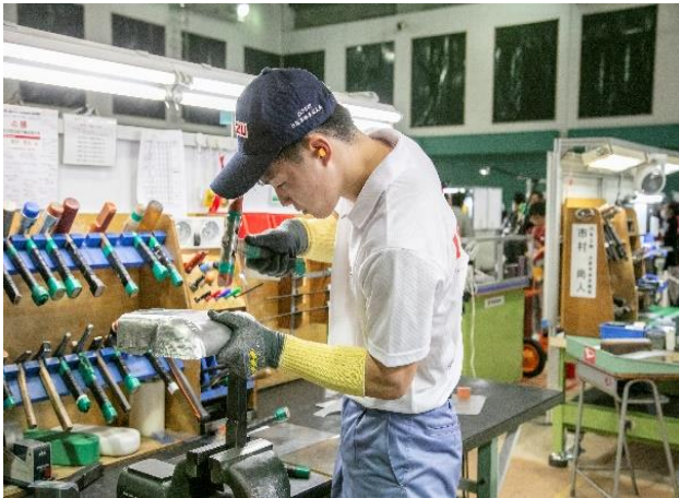
図1 各種板金ハンマーによる絞り作業
