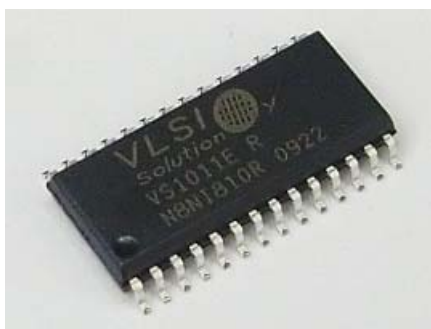
図 2.1 MP3 デコーダ VS1011e (SOP パッケージ)
